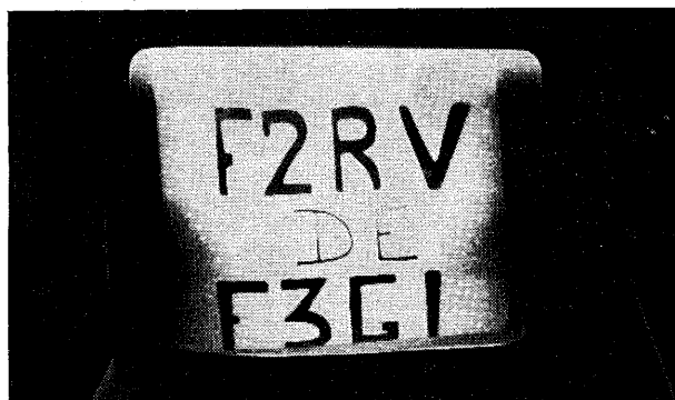
Fig. 2. - La réception à la station F2RV sur un téléviseur multistandard du commerce dont le tuner a été adapté. F3GI, distant de 2 kms à vol d'oiseau procédait à des essais sur antenne fictive. Chez F2RV, antenne collinéaire à rideau.
