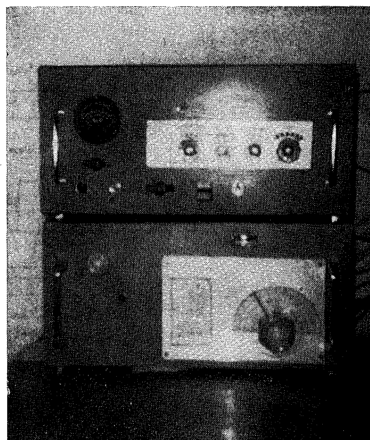
Détails de la station F1BJN : en haut : l'émetteur, après modifications, qui couvre la bande amateur des deux mètres par fréquences cristal. En bas : le récepteur, qui permet la réception du 144 MHz et autres bandes de fréquences comprises entre 20 et 200 MHz.
