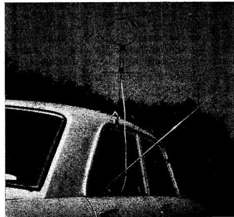
Vue d'ensemble des deux antennes. L'antenne UHF et VHFIII est commandée par le bouton de la fig. 1 grâce à une tige amovible et un petit manchon d'accouplement.
