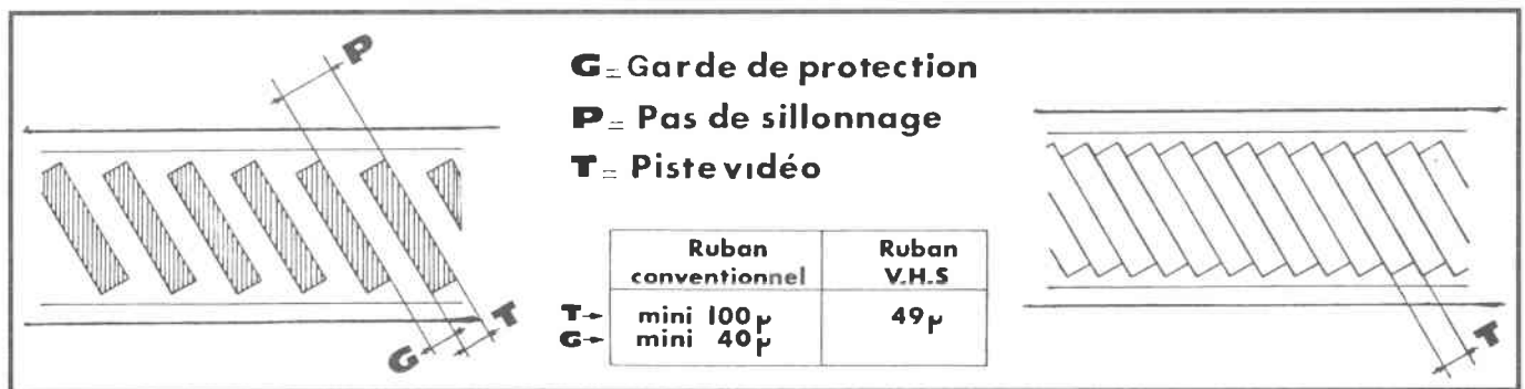
Figure B - A gauche, système conventionnel. A droite, système VHS.
