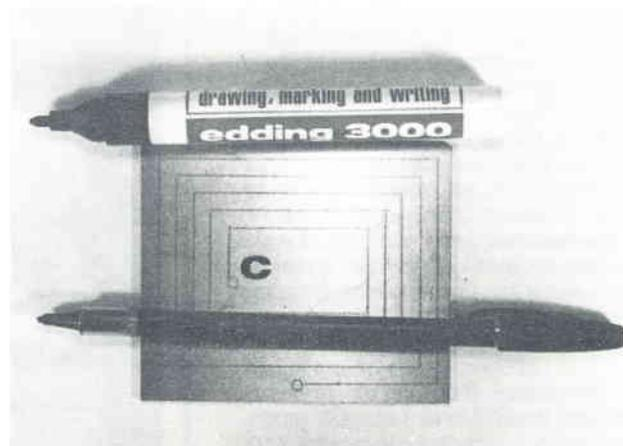
Photo 2. - Tracé de la couche protectrice sur la spirale au moyen de l'un des deux «feutres» indélébiles.
