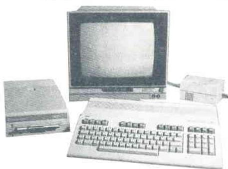
**COMMODORE 128** Microprocesseur Z 80A + 8502, 8 bits. — Mémoire morte 96 ko ; mémoire vive 128 ko. — Clavier Qwerty avec pavé numérique et 8 touches de fonction programmables. — Ecran 25 lignes de 40 ou 80 caractères, 640 x 200 points, jusqu'à 16 couleurs. — Langage Basic. — Système d'exploitation CP/M. — Périphériques : 1 lecteur de disquettes 13 cm, moniteur monochrome ou couleur, imprimante. — Interface parallèle.
