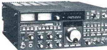
**YAESU - FT 757QX.** Transceiver décimétrique couverture générale de 150 kHz à 30 MHz en réception, émission bandes amateurs. Tous modes. 100 W. Alimentation 13,8 Vdc. Dimensions 238 x 93 x 238 mm, poids 4,5 kg. Option interface de télécommande pour Apple II.
