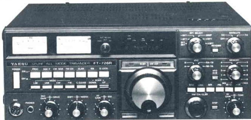
**CINQ BANDES AU CHOIX :** Equipé d'origine du module VHF 144 MHz, 2 modules supplémentaires au choix peuvent être ajoutés : module HF 21 - 24,5 - 28 MHz - module HF 50 MHz (émission autorisée en Région 2) - module UHF 430 MHz (équipé d'un préampli GaAs FET en réception).
