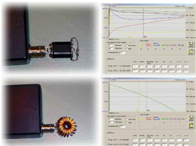
Les photos ci-dessus représentent des mesures réalisées avec le MiniVNA. En haut un balun, en bas une inductance. A côté d'eux leur courbe respective.
