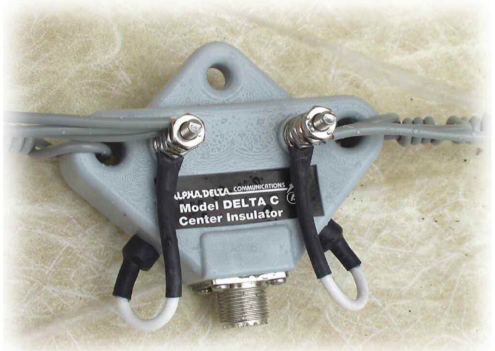
L'isolateur central où viennent se rejoindre les trois paires de fils. Il sert surtout de transformateur d'impédance de rapport 1,5/1 et transforme la symétrie du doublet à l'asymétrie du câble coaxial.
