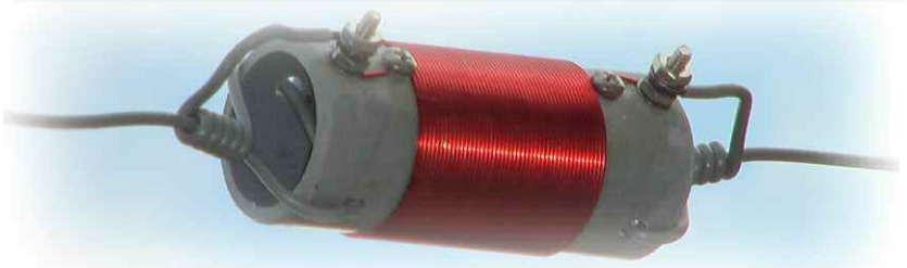
L'un des côtés du transformateur d'impédance de rapport 1,5/1. On voit nettement le départ des trois fils destinés aux trois bandes préconisées.
